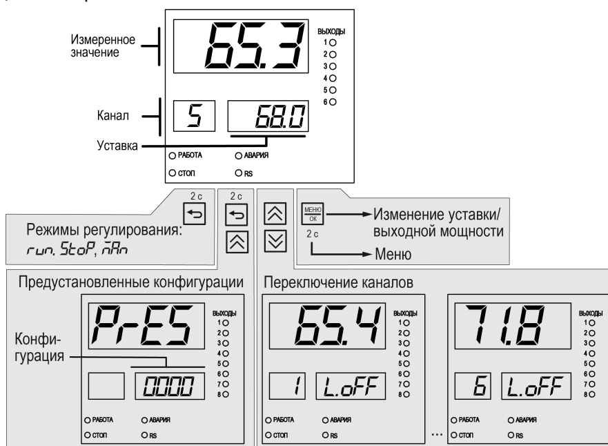
Рисунок 6.3 – Схема переходов с главного экрана
