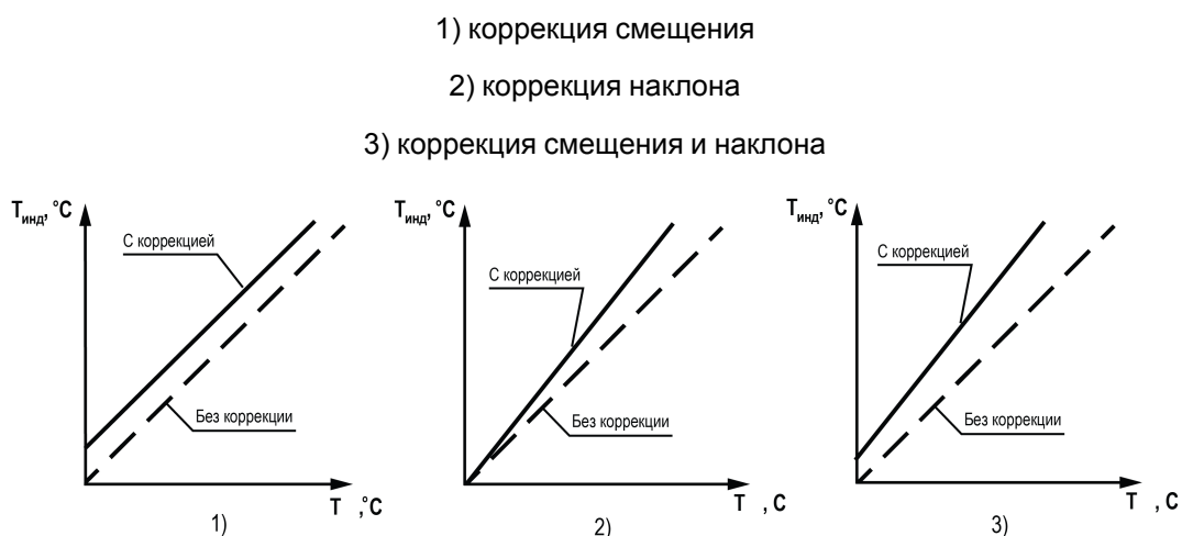
Рисунок 7.4 – Коррекция графика измерителя:
