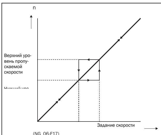
Рис. 88 Пропускаемая скорость
