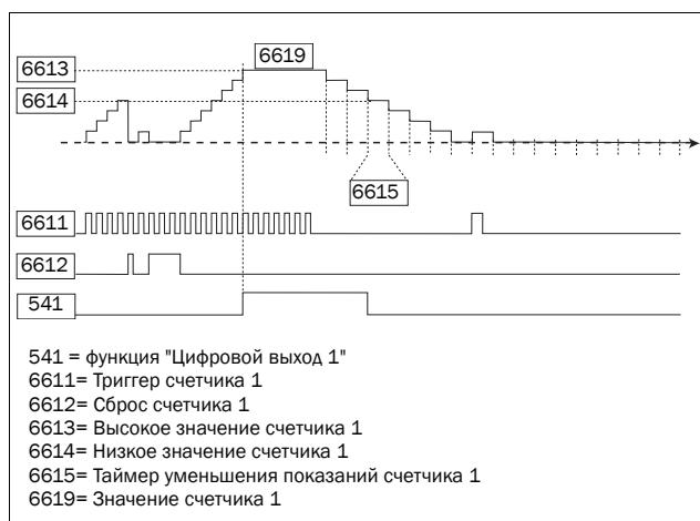
Рис. 122 Счетчики, принцип действия.
