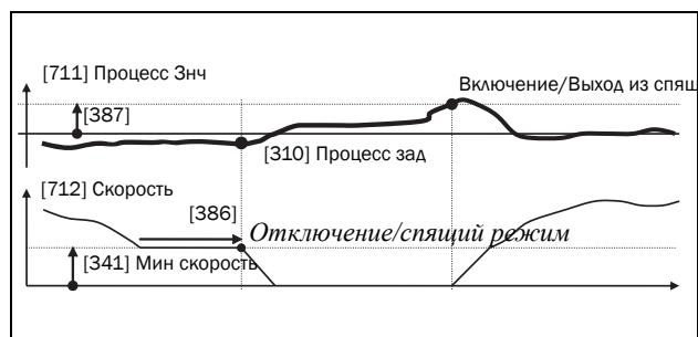
Рис. 95 Отключение/спящий режим ПИД при обратном ПИД-управлении
